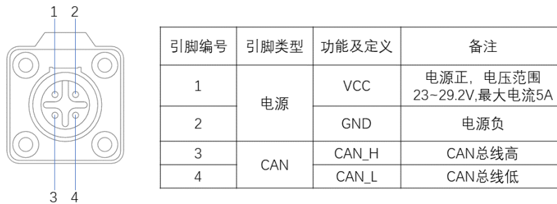
图 2.7 尾部航空接口引脚说明图
