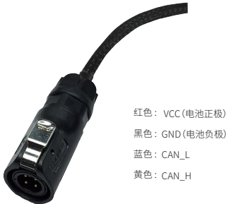
图 3.2 航空插头头头示意图
