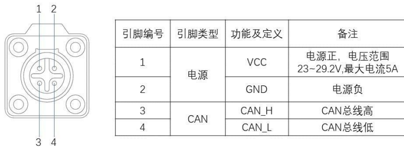
图 2.7 尾部航空接口引脚说明图
