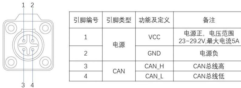
图 2.7 尾部航空接口引脚说明图
